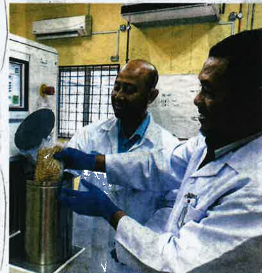
DR. SOBRI Hussein (kiri) dan Penolong Pegawai Sains Nuklear Malaysia Shuhaimi Shamsudin memasukkan benih padi MR 219 ke dalam bekas sebelum dilaruhkan dengan sinaran gama menggunakan mesin GammaCell.
