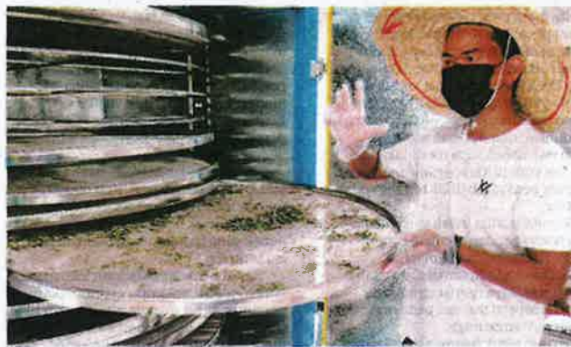
SEBANYAK kira-kira empat mesin bagi memproses pudina meliputi pengasingan aroma, pengeringan, pengecilan saiz dan pembungkusan terdapat di kebun pudina mereka.
