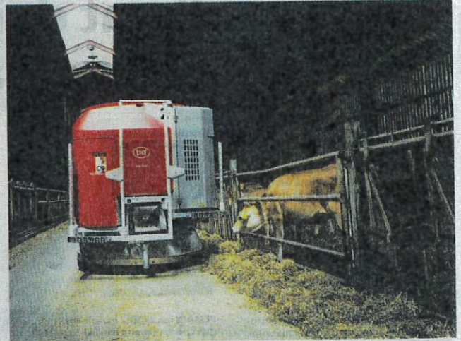
TUGASAN memberi makan lembu-lembu turut dilakukan oleh robot secara teratur sekali gus mengurangkan keperluan tenaga manusia.
