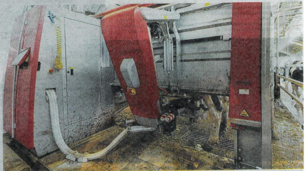
LELY Astronaut merupakan robot perahan susu yang mampu melakukan kerja secara automatik apabila lembu betina bersedia.
