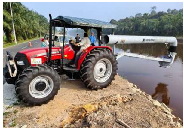
Trailer untuk Pam Air Tractor Mounted supaya pam air dapat digerakkan dengan mudah di kawasan apabila diperlukan.
