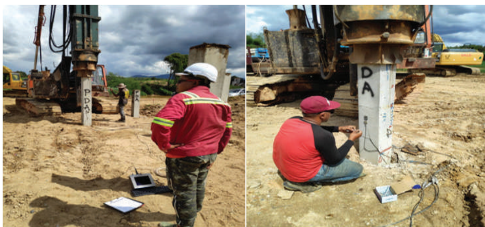
Ujian PDA di struktur muka sauk
