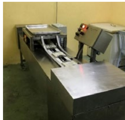
Mesin Inti dan Kelim Karipap Semi Auto yang Diperolehi Melalui Projek Geran Pemadanan CUP di Bawah Skop Peningkatan Kapasiti Pengeluaran.
